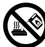
Giet nooit vloeibare brandstof in de hete Bio-Burner!
