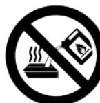
**¡No eche nunca combustible líquido en el Bio-Burner caliente!**
